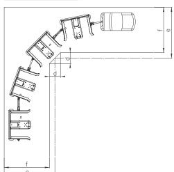
d = chamfered edge (45°) e = aisle width without chamfered edge f = aisle width with chamfered edge
